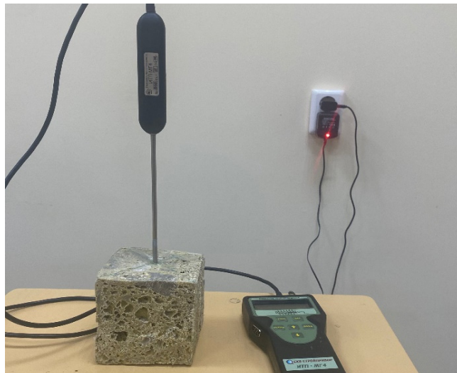
Рисунок 1 – Измерение теплопроводности образцов
