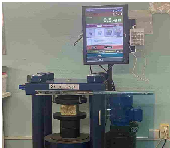
Рисунок 2 – Испытание образцов на прочность на сжатие
