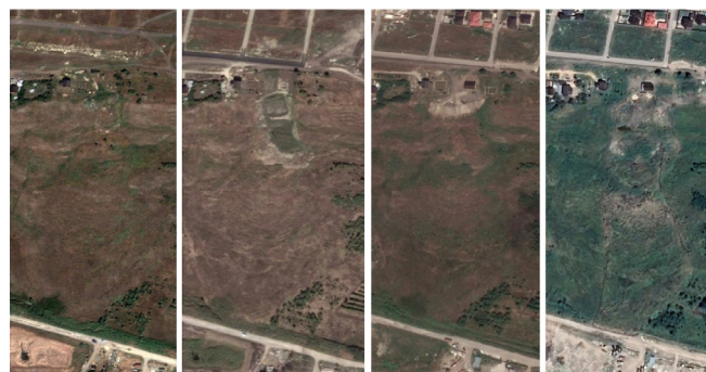
Рис. 2. Оползень у строящегося частного дома в ДНТ Станкостроитель-2, 41Б (спутниковые снимки 2010, 2011, 2015, 2016 гг.)
